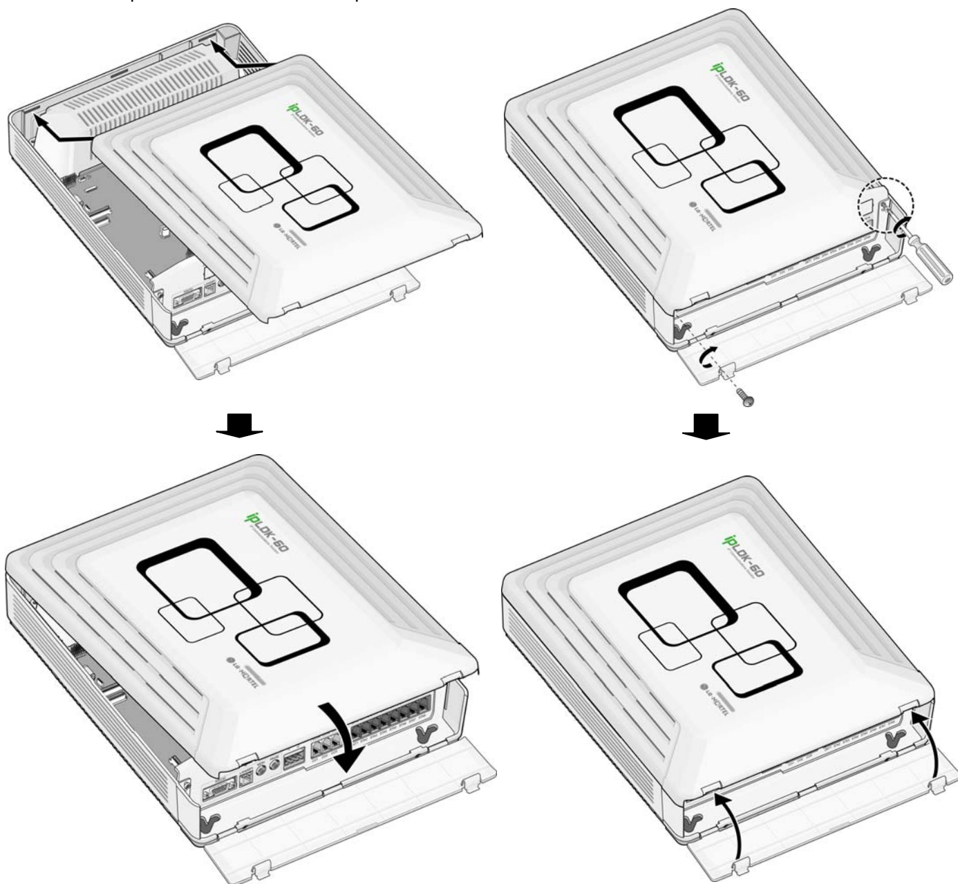
Рис 3.2.3.2 Установка лицевой панели
