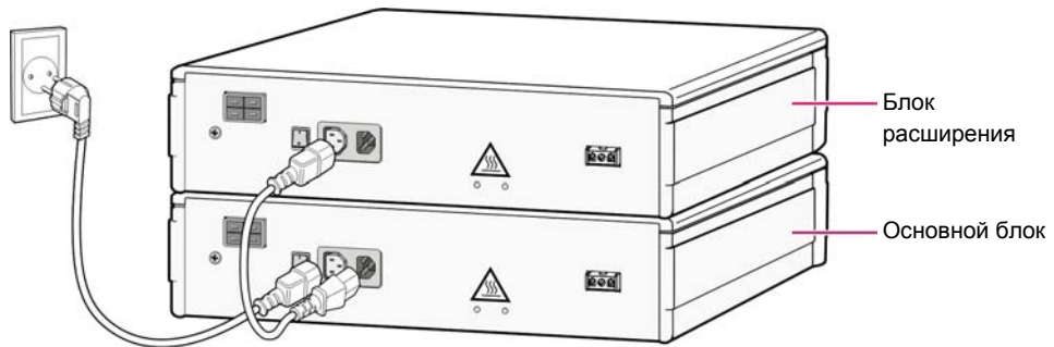
Рис. 5.3 Подключение питания (с помощью кабеля-удлинителя питания)
