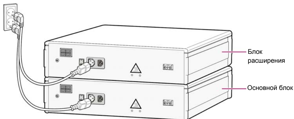
Рис. 5.2 Подключение питания (с помощью кабеля питания)
